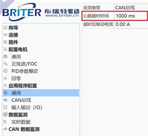
**注意：心跳和控制模式无关，建议单独新增线程，周期更改心跳寄存器的值。不管处于任何模式，都需要更新心跳的值。否则驱动器会放空电机，不能正确响应控制指令。**
